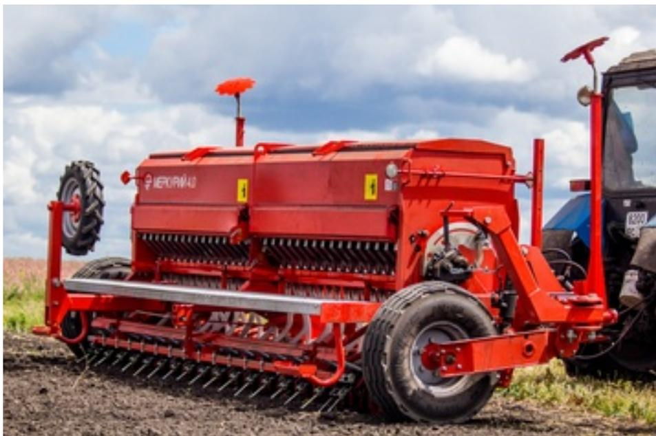
Сеялка МЕРКУРИЙ – 4.0 предназначена для рядового посева с одновременным внесением удобрений семян зерновых (пшеница, рожь, овес, ячмень), зернобобовых (горох, бобы, соя, люпин), близких по размерам к зерновым культурам (просо, сорго и др.).
