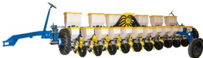
Сеялка предназначена для точного высева калиброванных обычных и дражированных семян свёклы (сахарной, кормовой и столовой) мелкой (3,5–4,5 мм) и крупной (4,5–5,5 мм) фракции.
