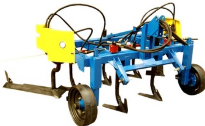
Предназначен для рыхления почвы и подрезания сорняков в междурядьях и рядах виноградниковых насаждений с шириной междурядий 3 метра.
